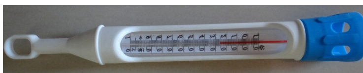
Figura 4 – Termômetro graduado na escala Celsius. Fonte: Foto do autor
