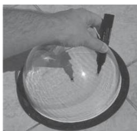
Figura 2 – Metodologia para encontrar a posição do Sol sobre a cúpula em determinado momento do dia.
