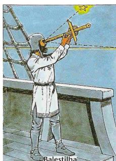
Fig 2: Uso da Balestilha para medir a altura de um determinado astro.
