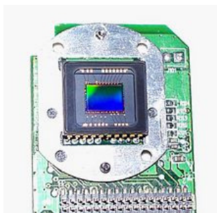
Figura 3: CCD com 2.1 megapixels de uma câmera fotográfica digital Hewlett-Packard (HP). Fonte: http://en.wikipedia.org/wiki/Charge-coupled_device
